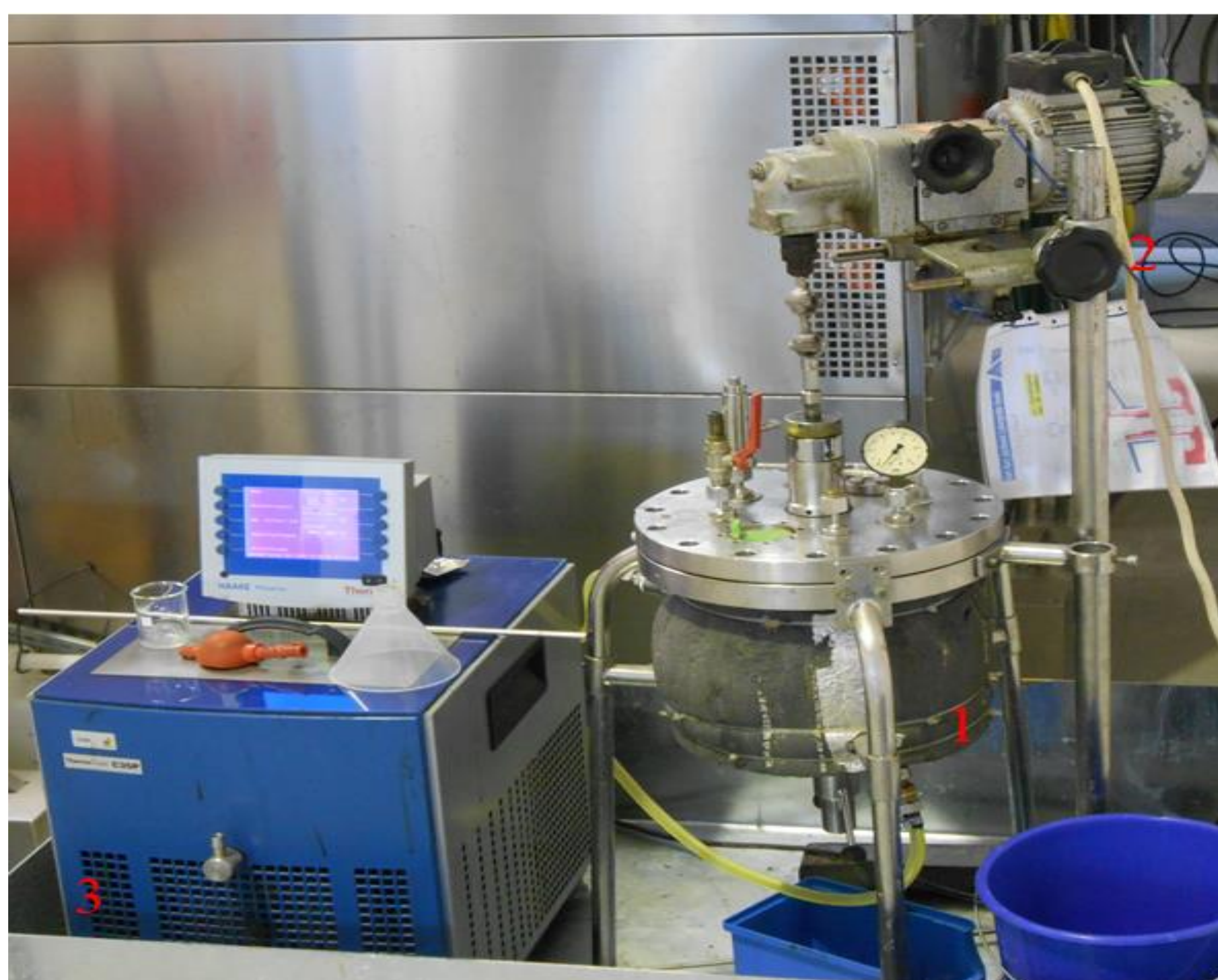
Abbildung 1: Versuchsaufbau der Hydrolyse des Restbrot in einem Rührreaktor. 1: Juvo-Labor-Reaktionskessel Juchheim Laborgeräte GmbH; 2: Rührerantrieb Heynau 4V1K3MZ; 3: HAAKE Phoenix II Kältethermostat
