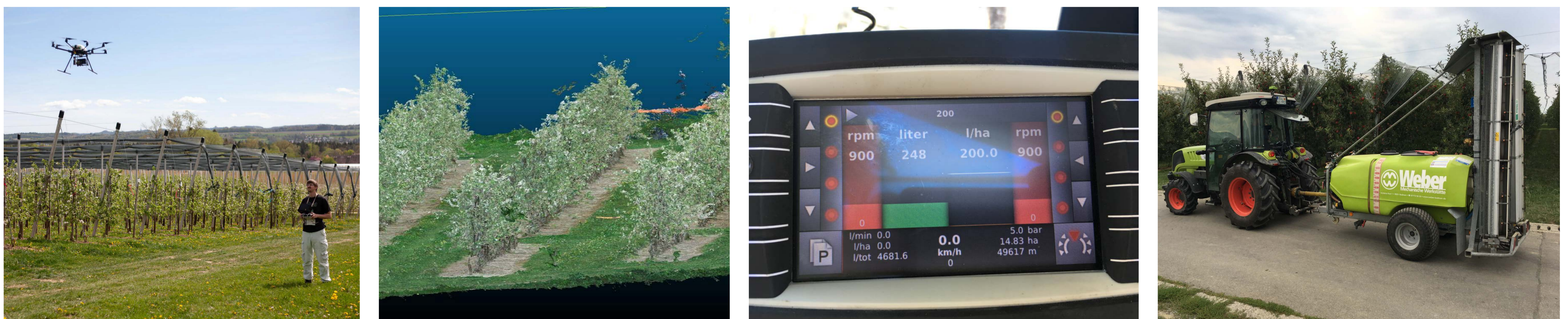
Abbildung 1 – (v.l.n.r.) UAV Befliegung einer Obstanlage am Versuchsstandort des KOB, anschließende Rekonstruktion von Baumstrukturen, Überführung von Baumhöhen auf den Spritzcomputer und die final aufgebaute und modifizierte Obstbauspritze mit Teilbreitenschaltung
