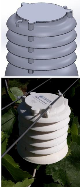
Abb. 1. (rechts) Neu entwickeltes Sensorsystem, bestehend aus Sendeeinheit und Sensor unter Strahlungshut als CAD-Zeichnung (oben) sowie angebracht im Weinberg (unten)
